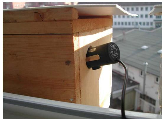
*Die Technik: Einfache lichtstarke USB-Kameras mit Brennweite 5-20cm, ohne eigene Beleuchtung. Die notwendige Helligkeit kommt einzig durch das Flugloch*
